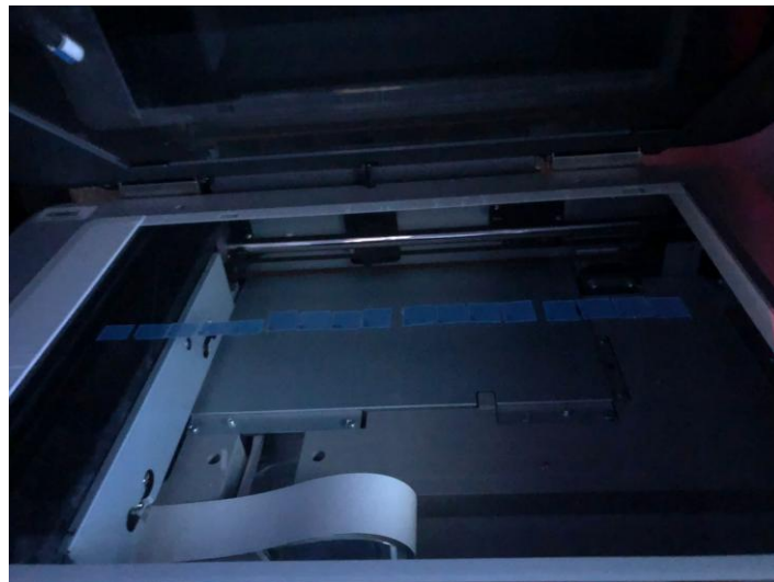
Fig 4.3. Posicionamiento de las películas en el eje de lectura central del escáner de cama plana.
